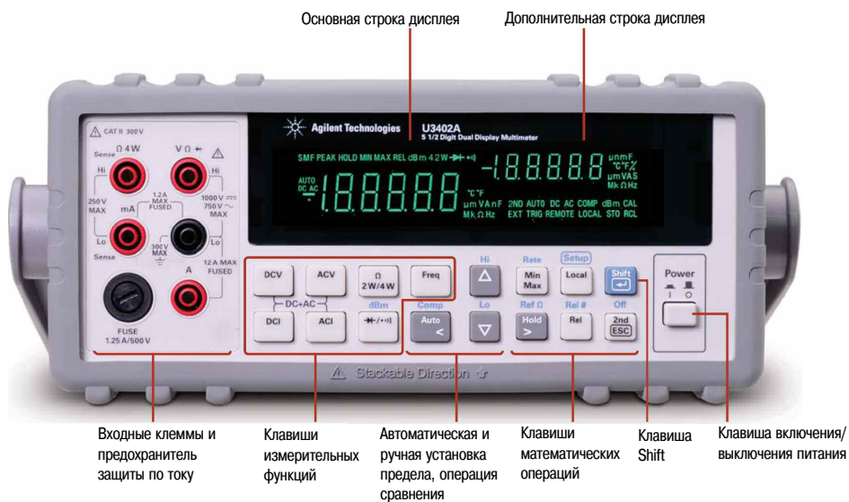
Рисунок 1. Передняя панель мультиметра U3402A. Передняя панель модели U3401A имеет аналогичный вид, за исключением незначительных отличий в расположении клавиш выбора некоторых функций. Для получения более подробной информации следует обратиться к руководству по эксплуатации и обслуживанию мультиметров U3401A (User's and Service Guide U3401-90001).
